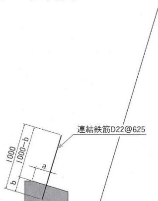
①基礎コンクリート打設時に、ブロック勾配に合わせて連結鉄筋D22(L=1000mm)を625mmピッチで配置し、同時打設する。(a、bの寸法はアンカー筋位置図にて御確かめ下さい。)
